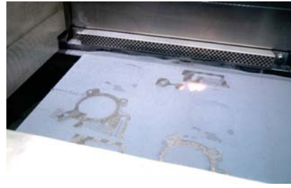
Figura 23: Una maquina de impresión 3D en metales por tecnología DMLS © Moreno Soppelsa | Dreamstime.com http://www.dreamstime.com/morenosoppelsa_info
