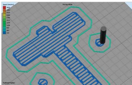
Figura 19: Ejemplo de camino para imprimir una capa
