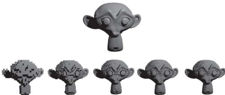
Figura 8: Representación de un objeto 3D con diferentes tamaños de vóxels. Puede observarse que al reducir el tamaño del vóxel mejora la resolución hasta el punto de ser imperceptible
