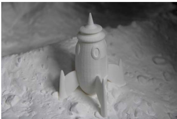
Figura 98: Un objeto producido por SLS, aún en la cama de polvo. Foto: Pixabay.
