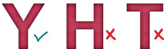
Figura 41: Las letras Y, H, T nos muestran la situación de overhang.
