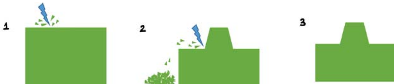
Diagrama 1.2: Proceso típico de fabricación sustractiva. (a) Partimos de un bloque de material; (b) eliminación de material hasta adquirir la forma deseada; (c) producto terminado.
