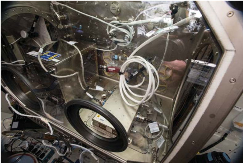
Figura 56: La impresora 3D instalada en la ISS, dentro de la cámara de microgravedad. Fuente / Image credit: NASA
