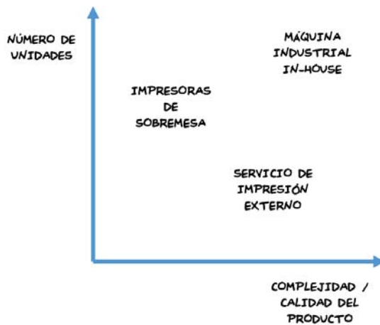
Figura 77: Opciones recomendadas de acceso a la impresión 3D en función del volumen y calidad del producto a fabricar.
