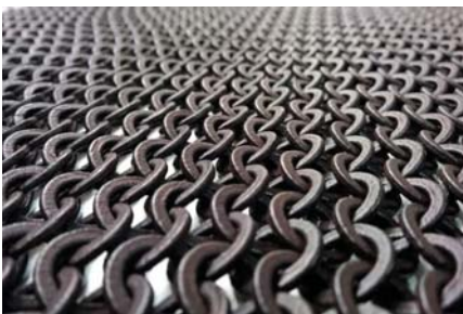
Figura 31: Cadenas impresas con los eslabones ya unidos entre sí. (Foto: Pixabay)
